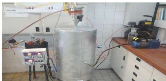
شکل (۱) - دستگاه خلأ-بخار-خلأ (VSV) مورد استفاده در تحقیق
